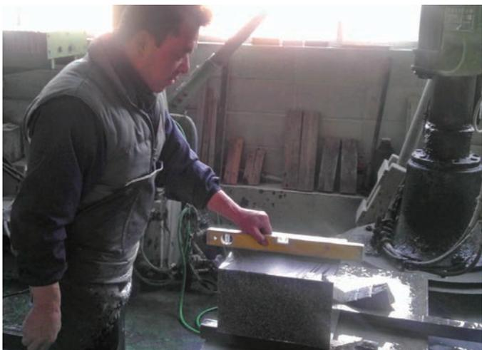
上の写真の道具を使い、水平・直角を直していきます。
