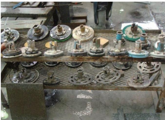
研磨する時の樹脂板です。上の写真の道具を7～8枚の樹脂板を使い光沢を出します。石種によっては、使う板も変わります。
