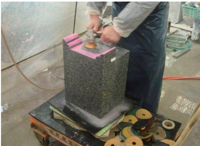
研磨作業と同様に7～8枚の樹脂板で光沢を出します。
