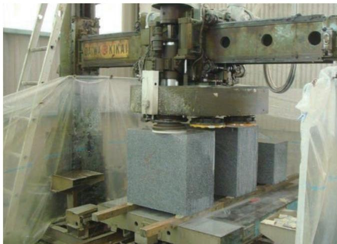
石種によっては、機械の圧力、回転数の調整を行い、光沢を出します。
