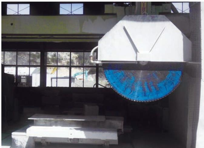
大きな原石を大割りするための機械です。大口径と呼ばれる人工ダイヤモンドの付いた刃は最も大きいもので直径3m60cmあります。
