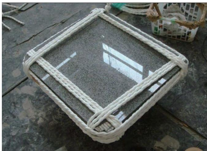
出来上がった製品が破損しない様に縄(ビニール製)で
